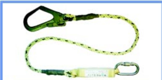
WSF210 สายช่วยชีวิตพร้อมอุปกรณ์สุดขีดแรงกระแทก ประกอบด้วยคาราบิเนอร์และตะขอสับขนาดใหญ่ เชือกขนาด 12 mm ยาว 1.8 เมตร ความยาวโดยรวม 2 เมตร อุปกรณ์สุดขีดแรงยาวสูงสุด 1.5 เมตร มาตรฐาน CE0120 EN355
