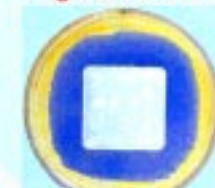
วัสดุที่ผสมกับ Microban ปราศจากแบคทีเรียอย่างเห็นได้ชัด
